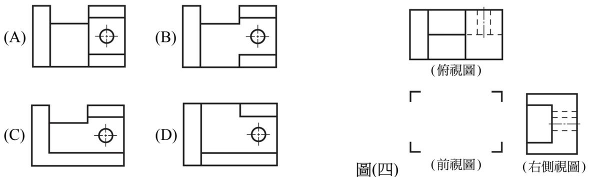
38. 如圖(五)立體圖所示，依箭頭方向投影，下列視圖何者正確？
